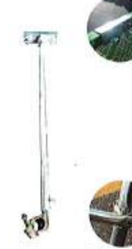
樹脂フェンス用サポート (単管クランプ付) 商品コード 4104-7201-07 サイズ φ32×L1050~1500mm 伸縮式 その他 材質：スチール製 表面：ドブメッキ処理 上部：フェンスバンド付 下部：単管クランプ付
