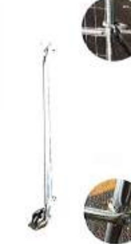
メッキフェンス用サポート (単管クランプ付) 商品コード 4104-7201-00 サイズ φ32×L1050~1500mm 伸縮式 その他 材質：スチール製 表面：ドブメッキ処理 上部：フェンスバンド付 下部：単管クランプ付
