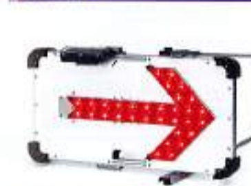
2WAYアロー 商品コード 4106-0103-10 サイズ H432×W770×D79mm 重量 5.0kg (単一形乾電池含まず) その他 LED数：各32個 乾電池：単一形×2本 ソーラー・乾電池自動切替機能付き
